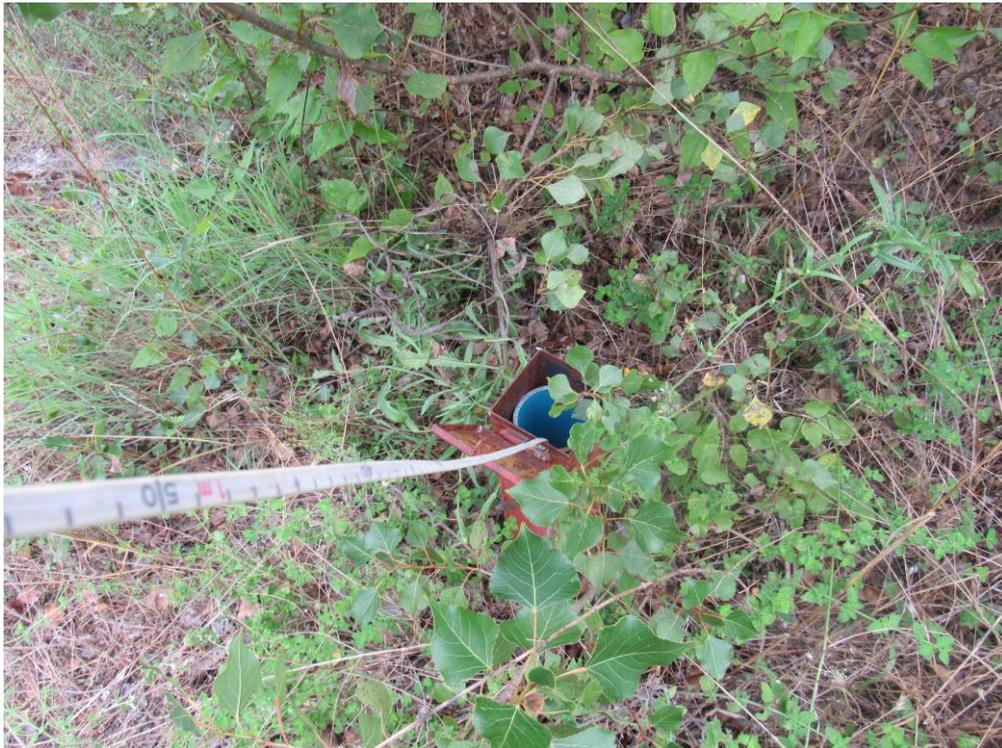
Figura 24 - Misura della falda acquifera.
