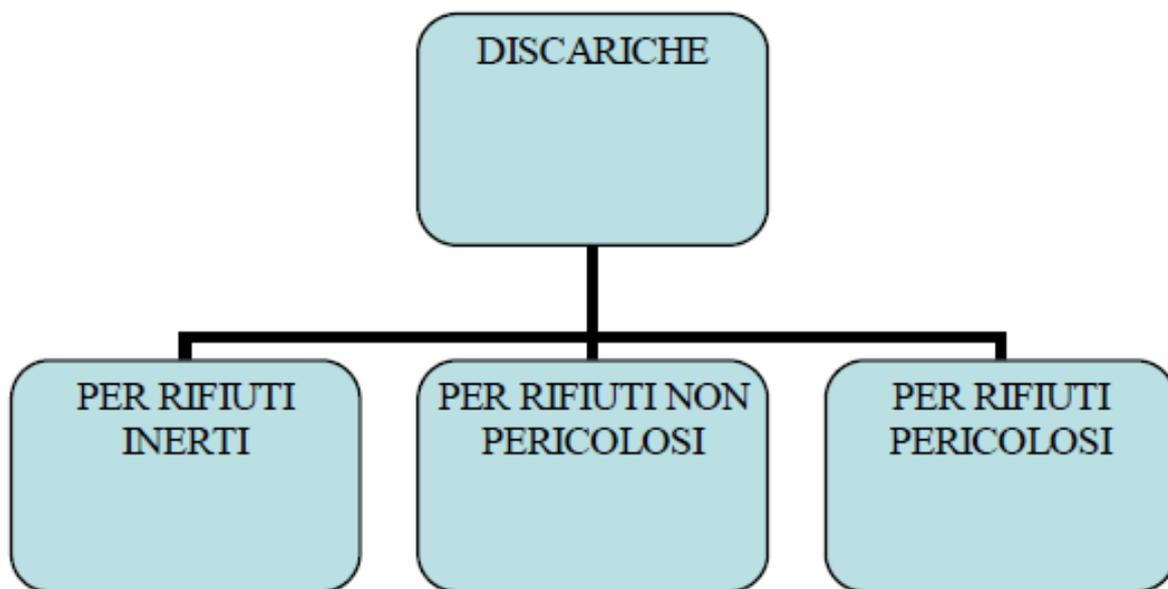
Figura 4 – Classificazione semplificata delle tipologie di discarica
