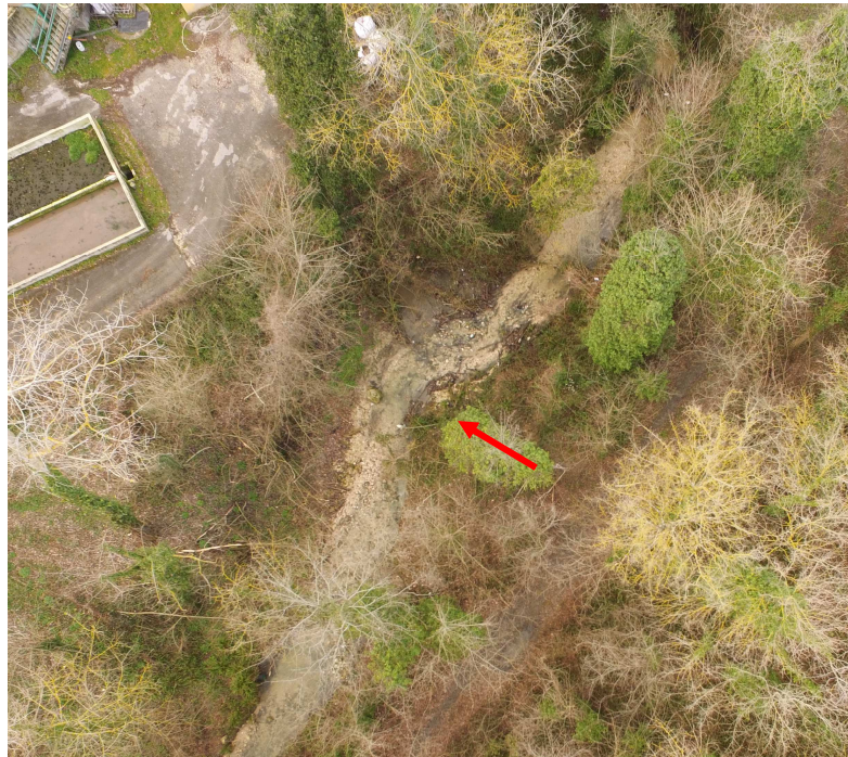
Foto n°3 – Smottamenti che hanno deviato il corso del torrente
