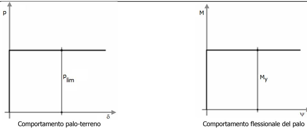
La resistenza limite laterale di un palo è determinata dal minimo valore fra:
