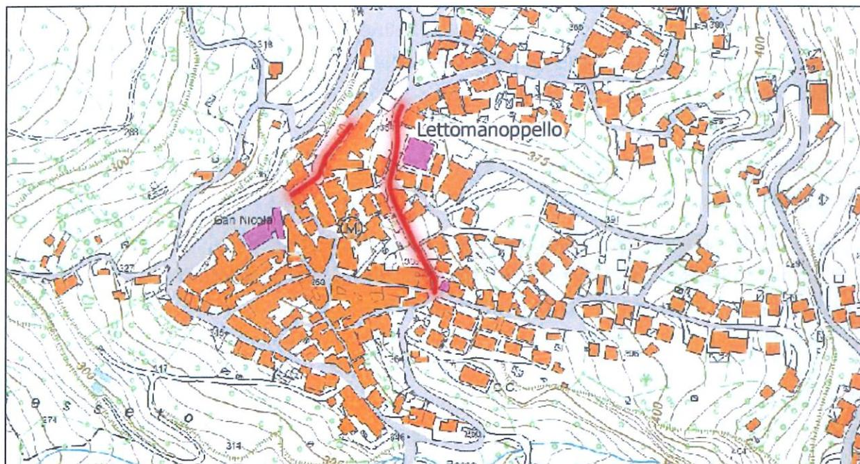
Il progetto di sostituzione della rete di distribuzione idrica prevede la posa della nuova tubazione esclusivamente all'interno delle sedi stradali esistenti.
