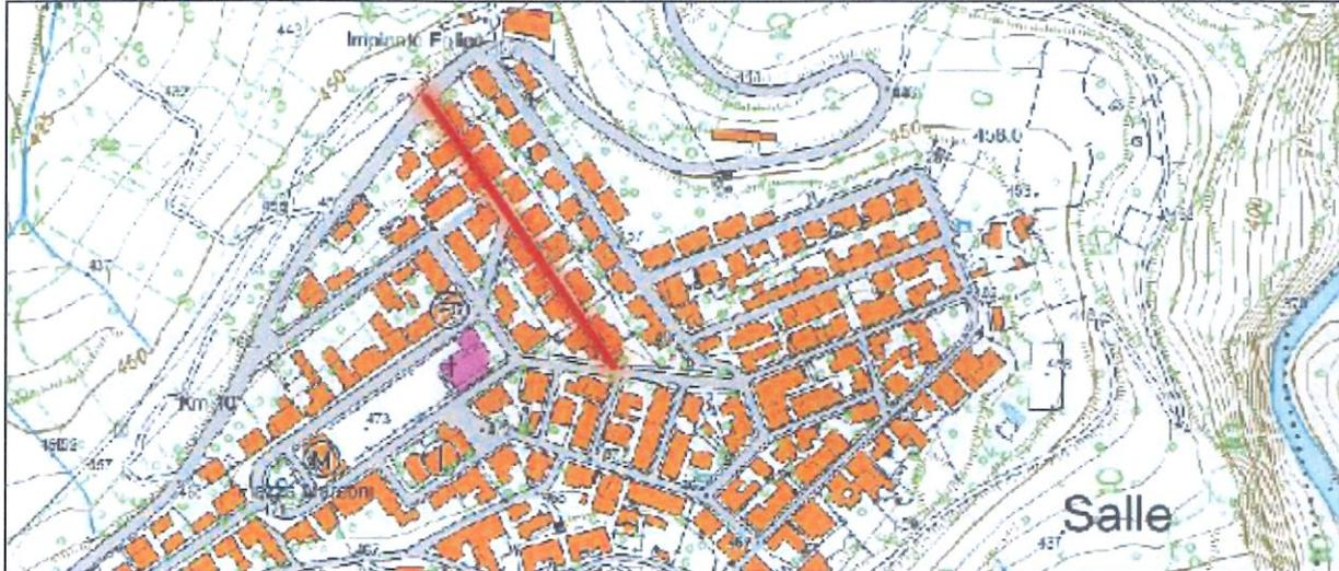
Il progetto di sostituzione della rete di distribuzione idrica prevede la posa della nuova tubazione esclusivamente all'interno delle sedi stradali esistenti.
