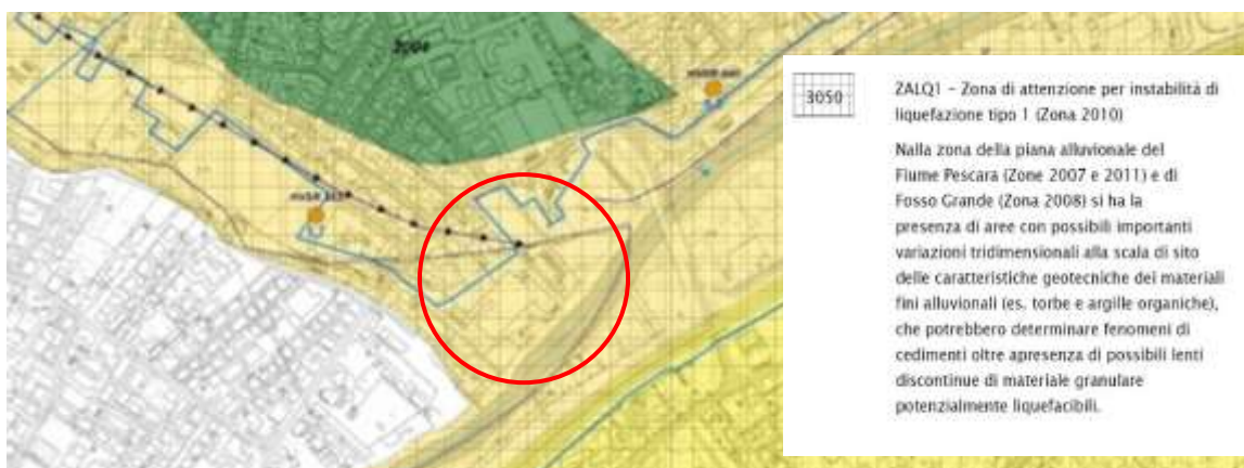
Figura 12 – Stralcio Carta delle Microzone Omogenee in Prospettiva Sismica (MOPS) con frequenze fondamentali di vibrazione – scala 1:5000 – Comune di Pescara
