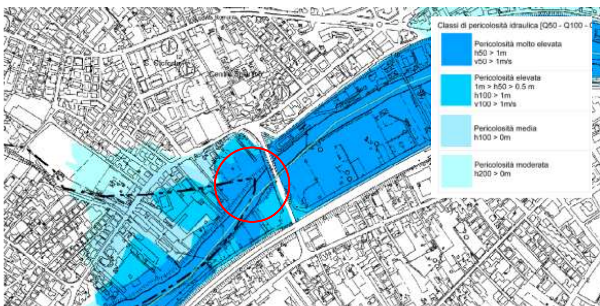
Figura 4 - Stralcio Carta della Pericolosità idraulica, elaborato n. 7.2.07.pe.01_AGG01
