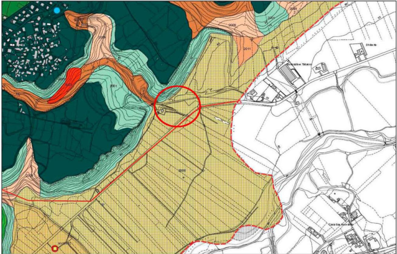
Nello studio di MZS viene prescritto, nelle zone suscettibili a liquefazione, la necessità di approfondimento per la verifica di detta instabilità. La verifica è stata eseguita ( relazione geologica del Dott Geol G Ciccone allegata al progetto ) , mediante il metodo proposto da Andrus e Stokoe (1997) è l'indice di suscettibilità a liquefazione è risultato molto basso.
